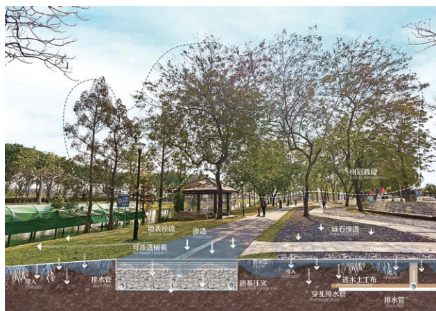
图7 透水材料与雨水管理图示
